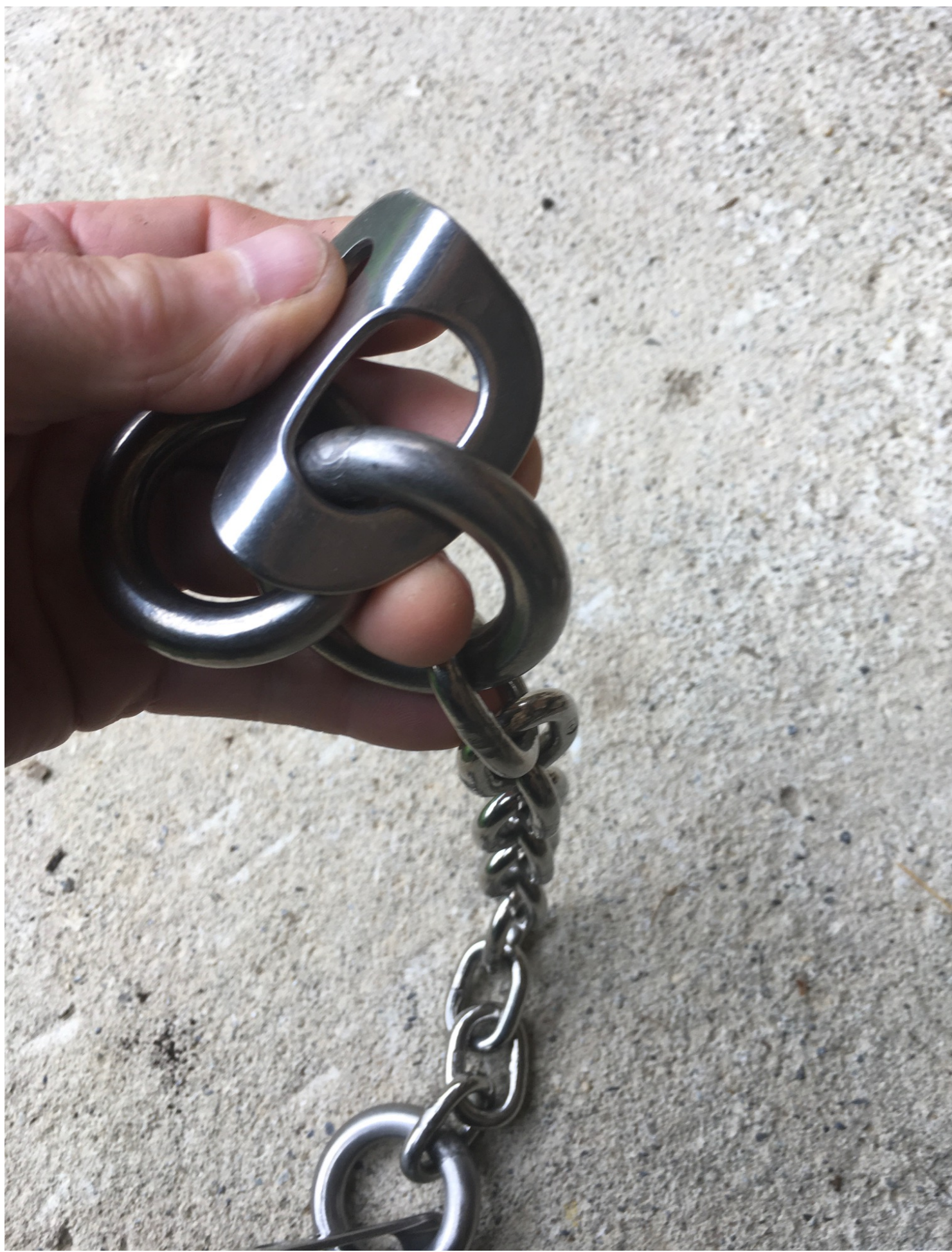
Chaîne et plaque inox A4 316L et boucles non A4
