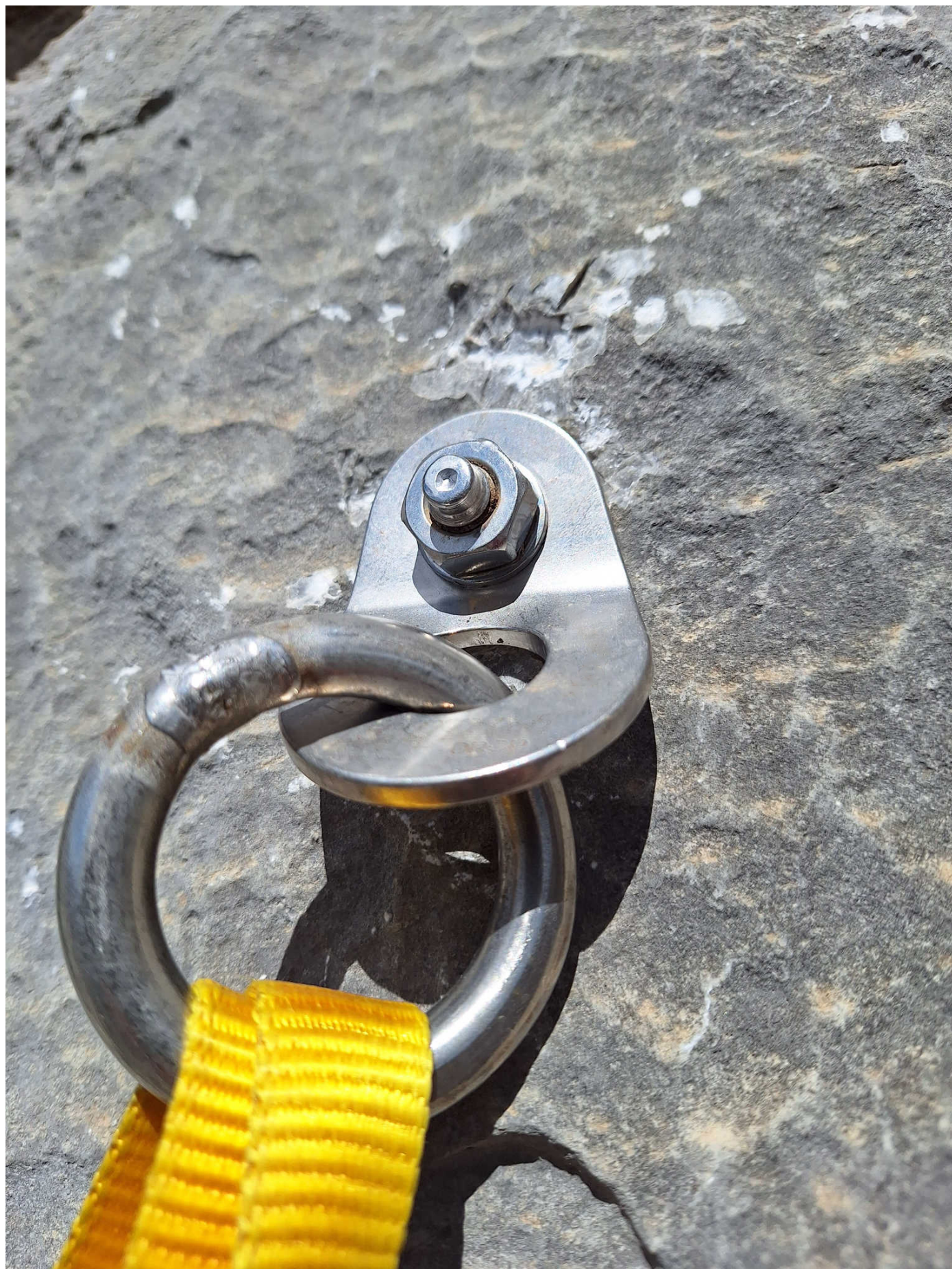
Plaquette et boucle A4 316L, posée en 2022, boucle déjà rouillée et fissurée en 2024, Leonidio, Grèce
